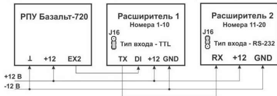
Рис. 3 Подключение расширителей к РПУ Базальт-720
