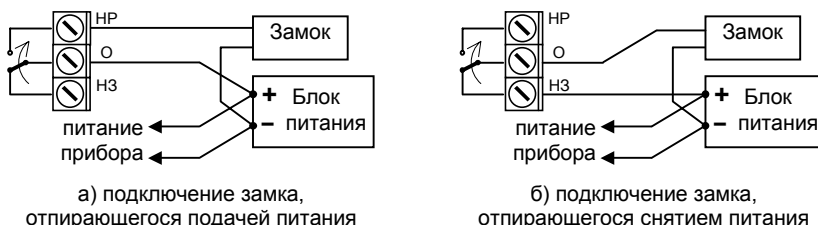
Рисунок 7 – Подключение электрического замка
