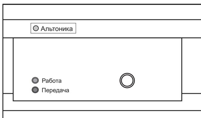
РАБОТА горит, когда передатчик включен, и мигает во время получения сигнала от панели. Красный светодиод ПЕРЕДАЧА загорается во время передачи извещения в эфир.
