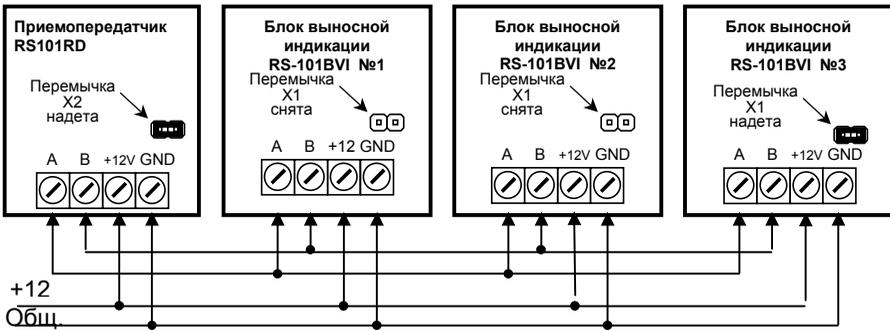
Рисунок 1 – Пример подключения нескольких БВИ к ПП
