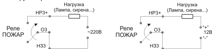
Рис. 1 – Примеры подключения нагрузки к реле ПОЖАР
