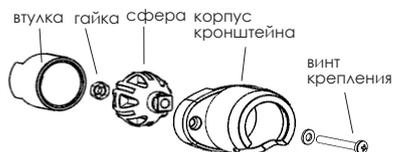
Рисунок 3 – Детали кронштейна
