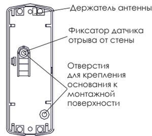
Рисунок 2 – Основание датчика
