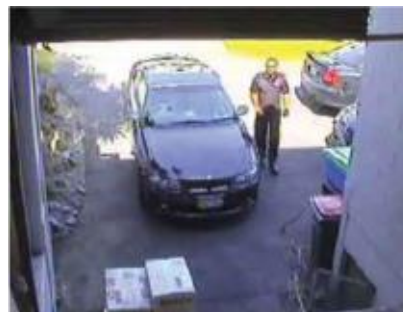
Режим WDR включен. Объекты видны отчетливо.
