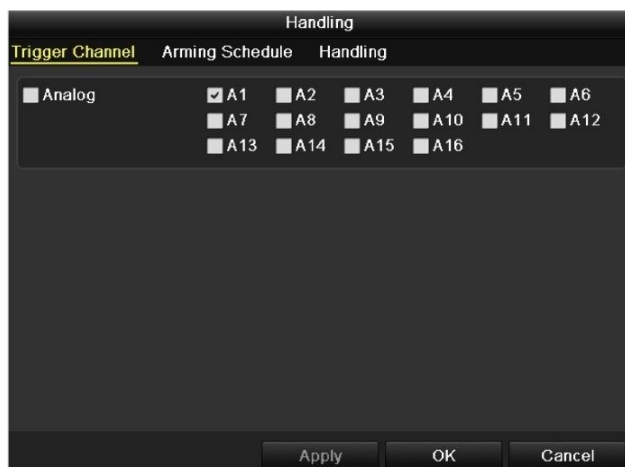
Рисунок 8.3 Установка камер, реагирующих на тревогу
