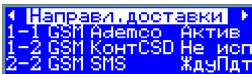
Рис. 27. Отображение состояния направлений доставки.
