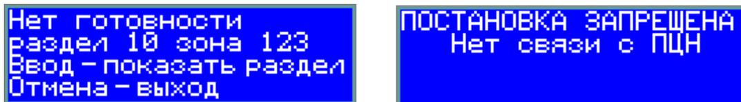
Рис. 15. Отображение проблем при остановке раздела под охрану.
