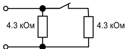
Применение оконечных резисторов позволяет определить четыре состояния шлейфа: **Норма, Тревога, Обрыв, КЗ**.
