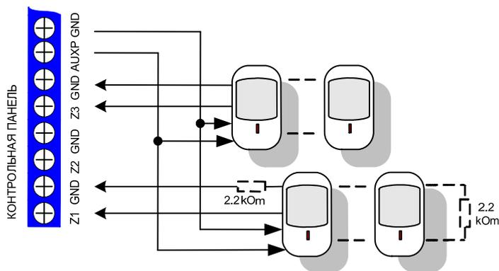
Рисунок 2 – Схема для подключения датчиков с/без оконечного резистора.
