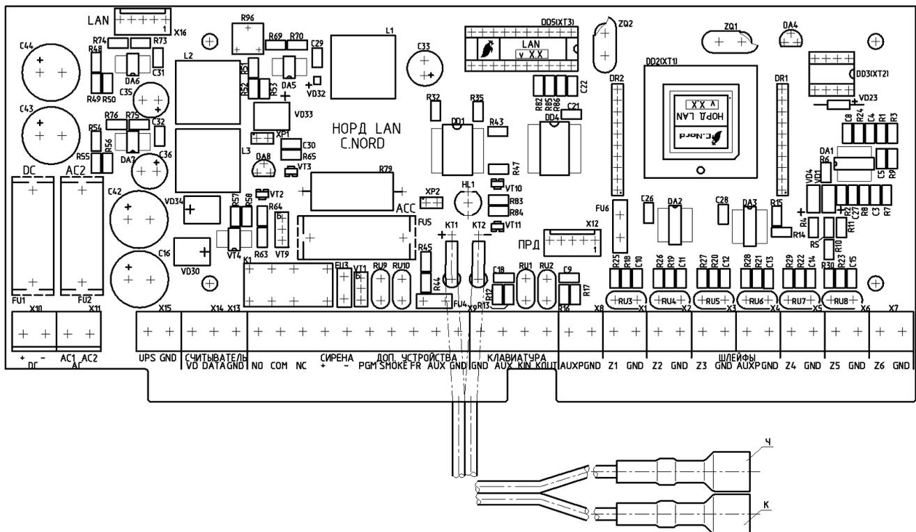
Рисунок 1 – Общий вид базовой платы прибора **НОРД LAN**
