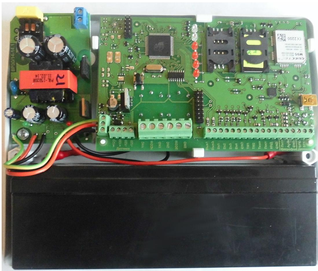
Включаем прибор в сеть 220В. После включения прибора необходимо выждать 10 секунд пока Прибор проводит тестирование. После окончания тестирования, должен начать мигать светодиод «GSM» - это означает, что происходит регистрация Прибора в сети GSM. Если Прибор зарегистрировался в сети, то светодиод «GSM» перестает мигать и начинает постоянно гореть.
