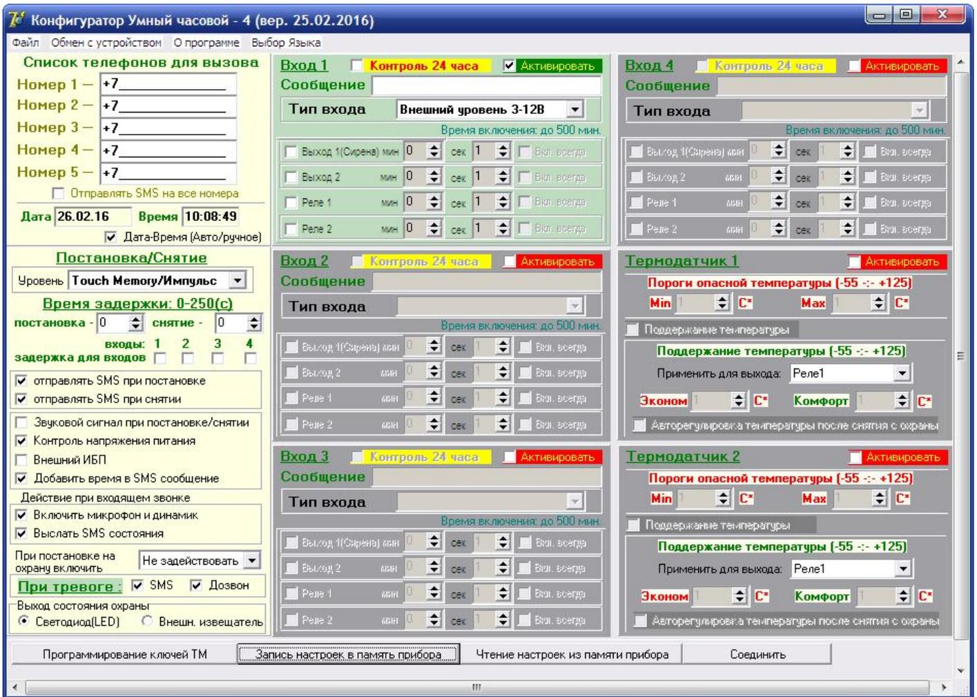
*Пояснение по конфигурации:* перед началом работы, нажимаем кнопку «Соединить» или выбираем пункт меню «Обмен с устройством»→ «Соединить». Программа производит поиск Прибора на всех доступных COM портах, и если Прибор обнаружен, то выводится сообщение:
