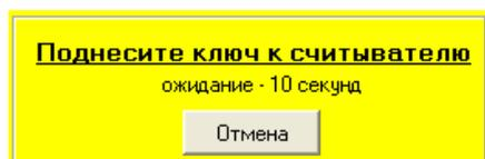
Необходимо поднести в течение 10с. ключ к считывателю, или нажать кнопку «**Отмена**». Если ключ был считан, код ключа отобразится в поле «**Код ключа**».
