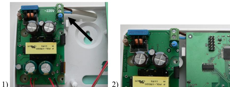
После подключения проводов, можно установить плату на место. Проверьте, надежно ли заизолированы контакты.
