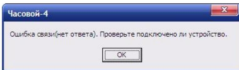
Одной из причин ошибки может быть неверная установка драйвера USB. Для того чтобы проверить установку, необходимо: нажать правой кнопкой мыши на ярлычке «*Мой компьютер*», затем выбрать пункт «*Свойства*» → «*Оборудование*» → «*Диспетчер Устройств*».
