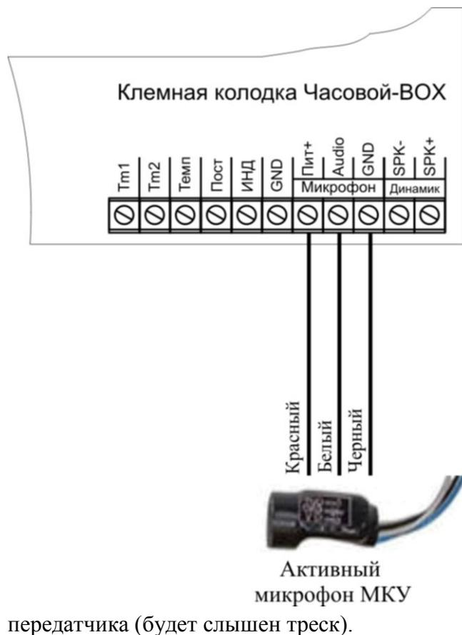
Для работы в составе системы используются специализированные микрофоны, допускающие подключение с помощью длинных проводов. Микрофоны такого типа имеют встроенный усилитель и три провода для подключения.
