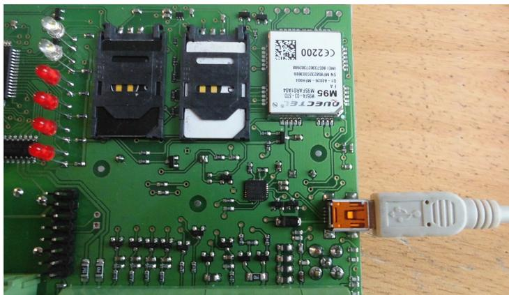
**Внимание!!!** После подключения Прибора к компьютеру через USB кабель в течение приблизительно 8 секунд проводится инициализация и запуск Прибора. В это время индикатор «~» горит слабым зеленым цветом, после процесса запуска загорается индикатор «GSM», теперь с Прибором можно работать.
