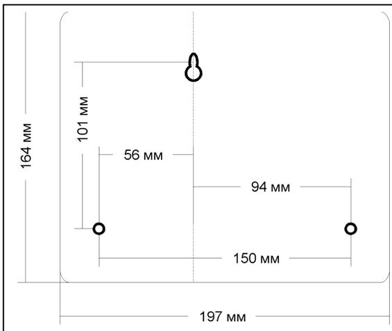
Монтажные кабели заводятся в прибор через отверстия в задней стенке корпуса. Место под платой можно использовать для укладки кабеля.
