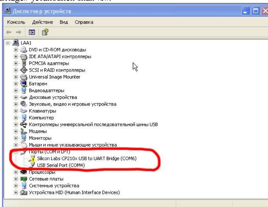
Для устранения ошибки, необходимо отключить Прибор от USB и перезагрузить компьютер. После перезагрузки подключить Прибор к USB разъему, ошибка должна быть устранена. Если перезагрузка не помогла, переустановите USB драйвер.
