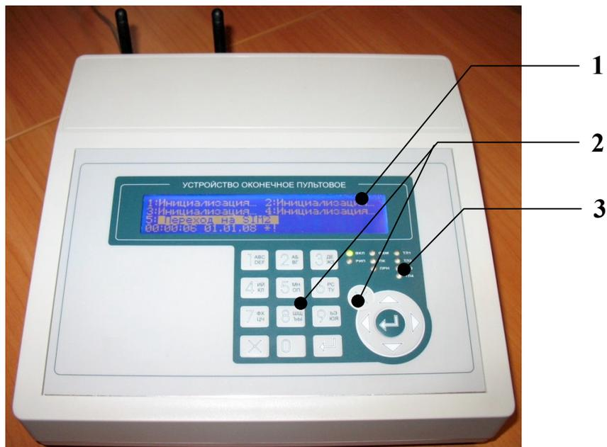
Рисунок 1. Передняя панель УОП
