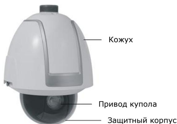
5 Дюймовая Высокоскоростная Купольная Видеокамера
