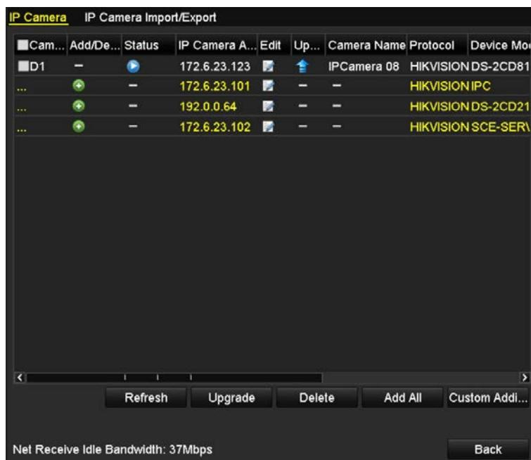
Рис 2. 16 Окно управления IP камерами
