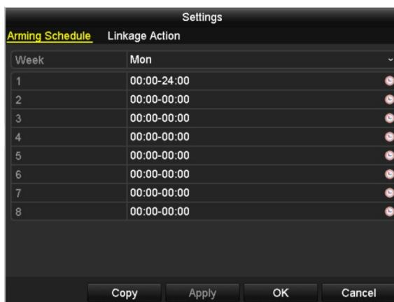
Рис. 8. 10 Установка расписания для тревог при потере видео
