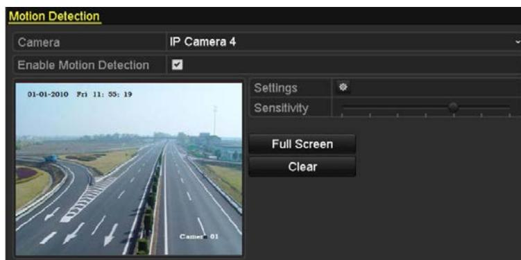
Рис. 8. 1 Интерфейс настройки детектора движения
