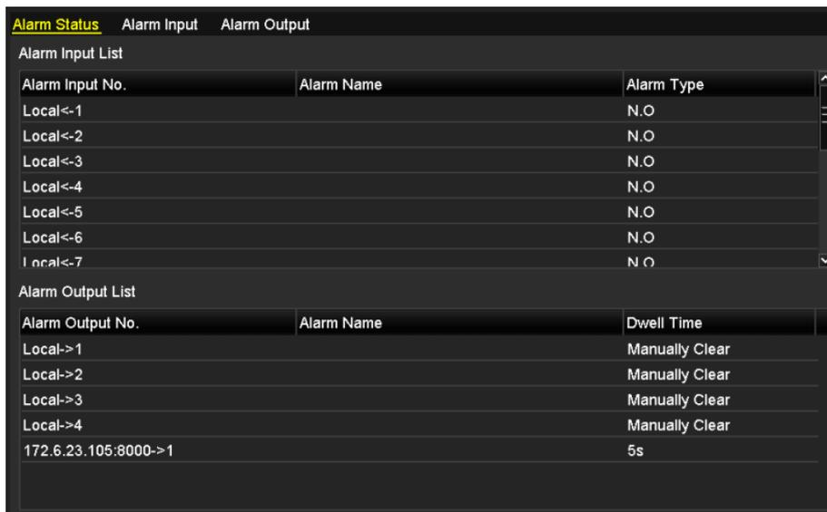
Рис. 8. 4 Интерфейс настройки тревог системной конфигурации
