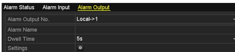
Рис. 8. 16 Интерфейс настройки тревожных выходов
