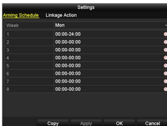
Рис. 8. 10 Установка расписания для тревог при потере видео
