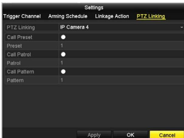
Рис. 8. 7 Установка действия PTZ по тревоге
