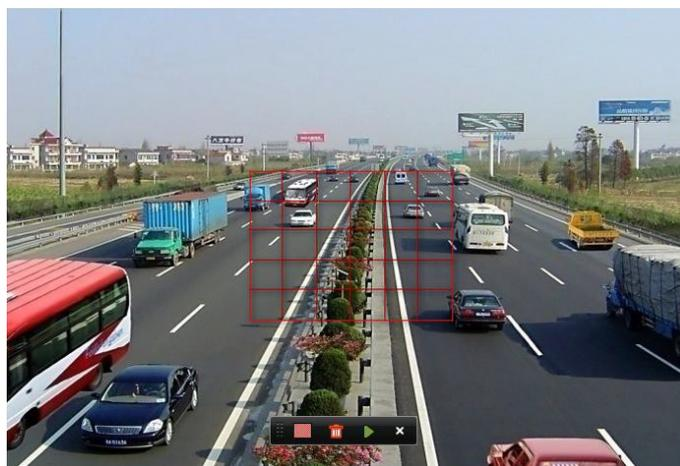
Рис. 6. 24 Выделенная зона умного поиска
