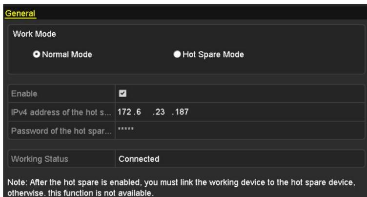
Рис. 7. 38 Установка режима для рабочего устройства
