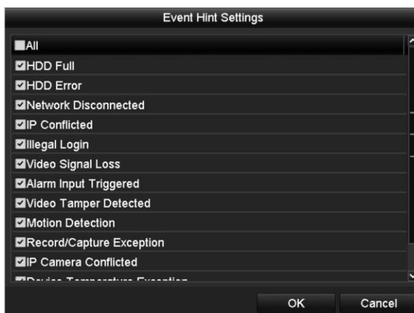
Рис. 8. 15 Настройка реакций на события
