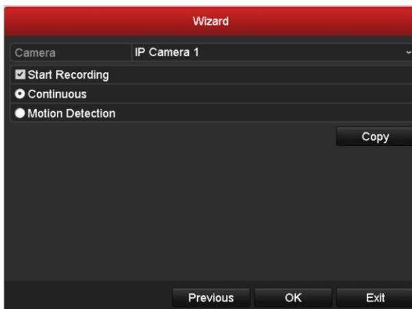
Рис. 2. 10 Настройки записи камер
