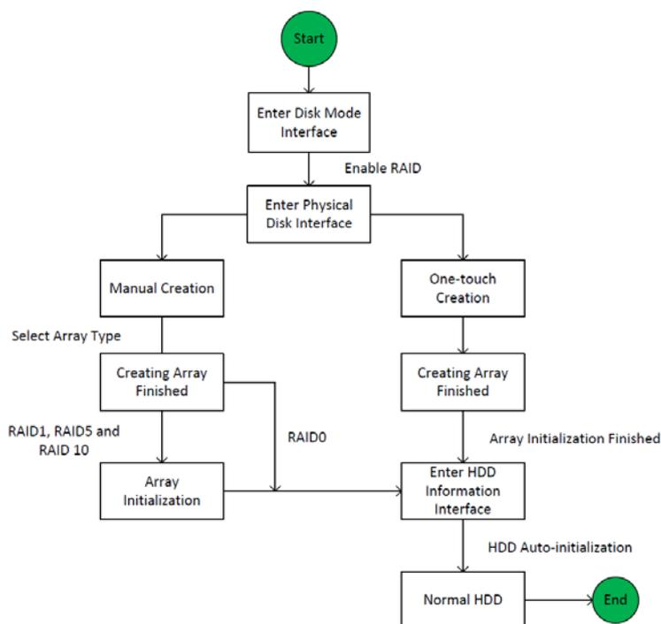
Рис. 11. 1 RAID Наcтройки процессов
