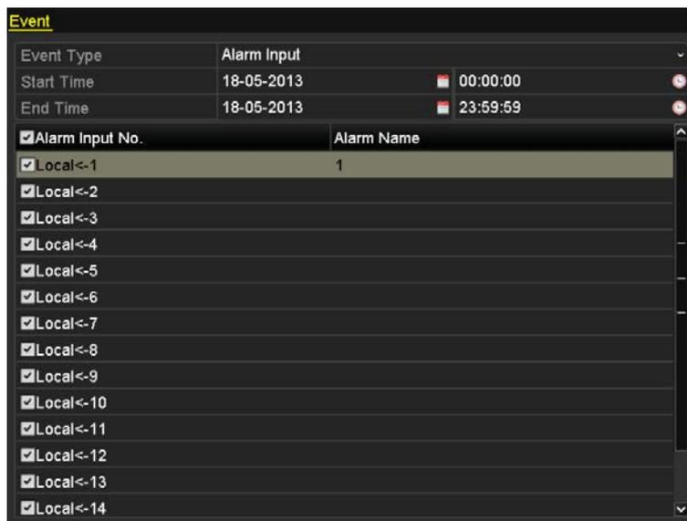
Рис. 7. 20 Поиск файлов видео по произошедшим событиям
