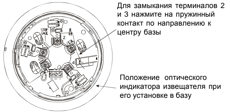
Рис. 1. Расположение терминалов
