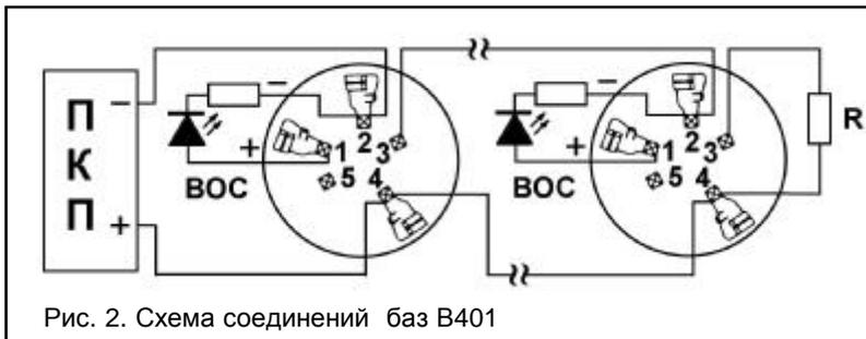
Рис. 2. Схема соединений баз В401
