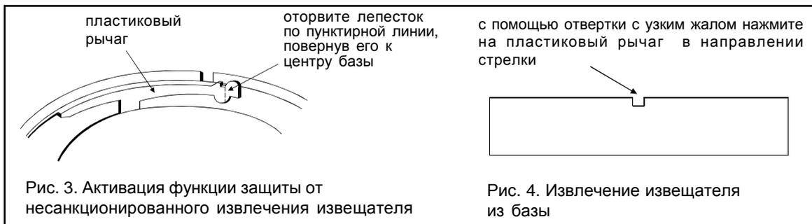
Рис. 3. Активация функции защиты от несанкционированного извлечения извещателя
