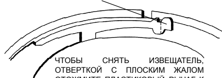
Рис.2. Защита от несанкционированного извлечения извещателя
