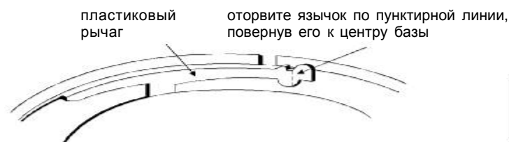
Рис. 1. Активизация функции защиты от несанкционированного извлечения извещателя
