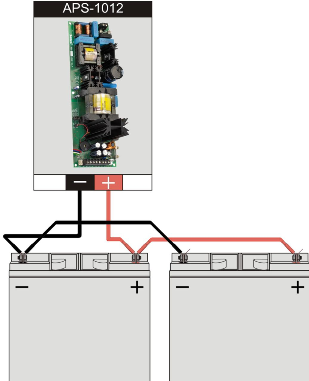
Рис. 4. Параллельное подключение двух аккумуляторов. Подключение можно осуществить с помощью кабелей, поставляемых в комплекте с устройством.
