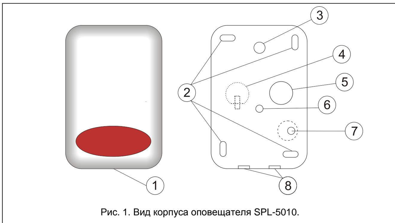
Рис. 1. Вид корпуса оповещателя SPL-5010.
