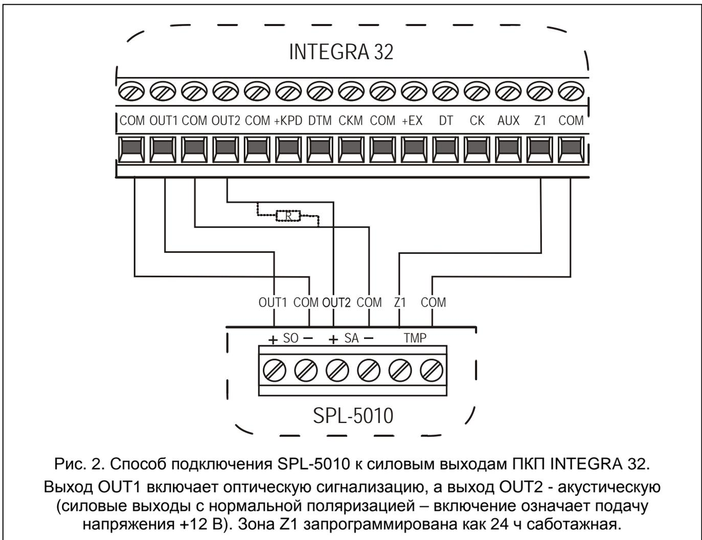
SPL-5010 может работать с любым источником тревожного сигнала, который в случае тревоги подает к тревожному выходу (выходам) напряжение +12 В DC или замыкает выход на массу. Звуковая сигнализация срабатывает при подаче напряжения питания +12 В к клеммам "+ SA -", а оптическая – к клеммам "+ SO -". Выбирая способ активации оповещателя, необходимо учитывать максимальный ток выходов ПКП
