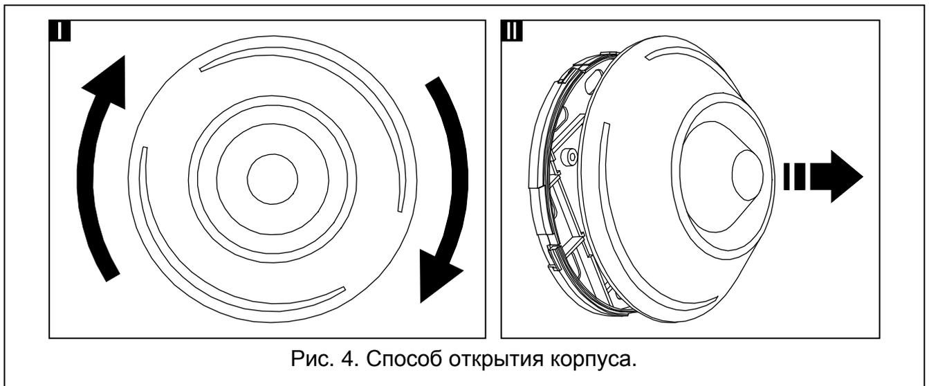
Рис. 4. Способ открытия корпуса.
