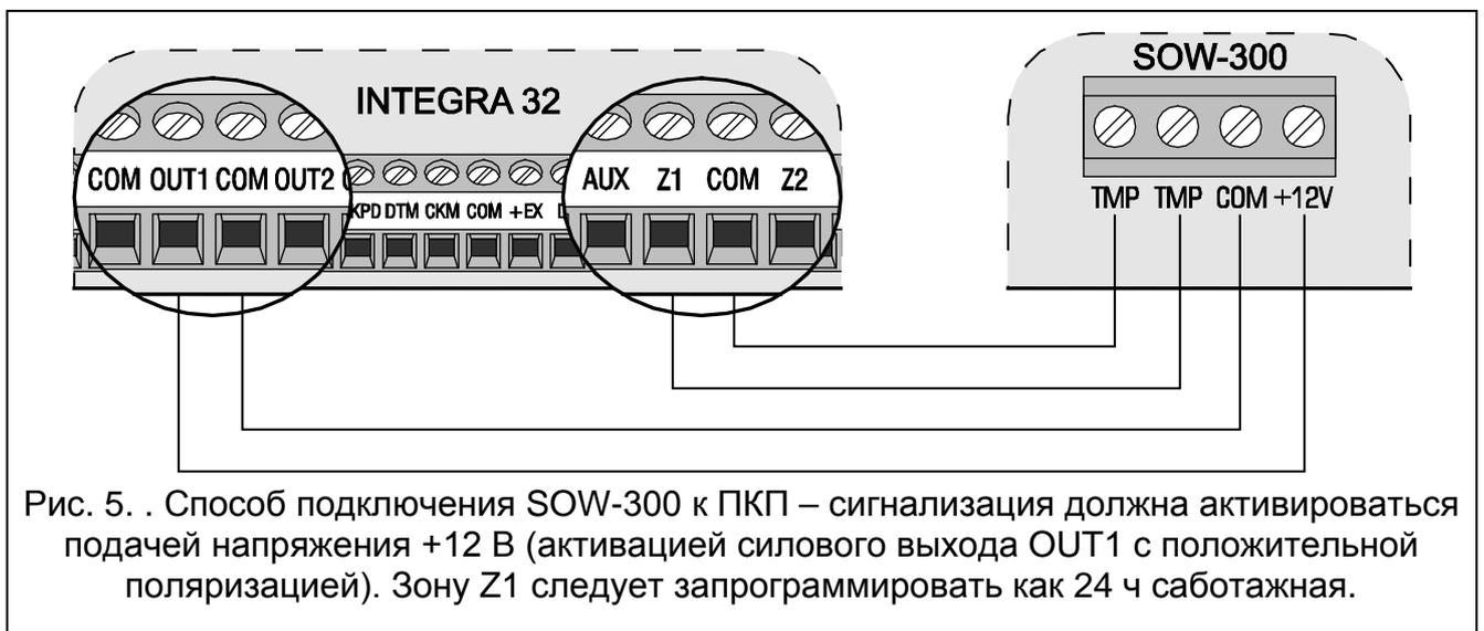
Рис. 5. . Способ подключения SOW-300 к ПКП – сигнализация должна активироваться подачей напряжения +12 В (активацией силового выхода OUT1 с положительной поляризацией). Зону Z1 следует запрограммировать как 24 ч саботажная.
