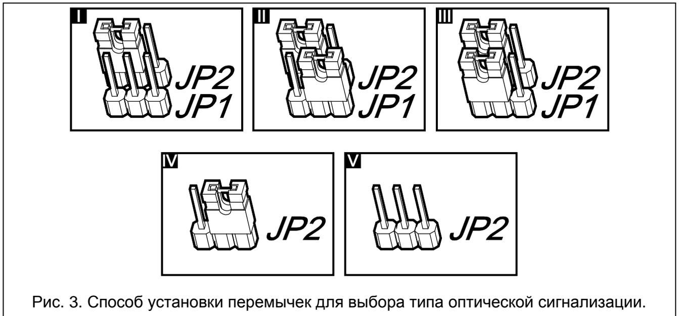
Рис. 3. Способ установки перемычек для выбора типа оптической сигнализации.
