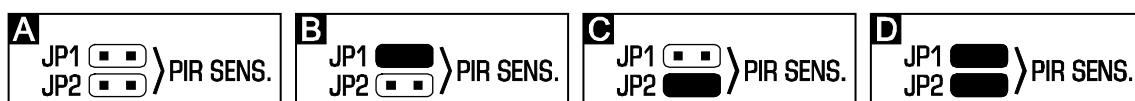
Рис. 2. Способ установки чувствительности извещателя (А – низкая чувствительность, В и С – средняя чувствительность, D – высокая чувствительность) [■ – штырьки замкнуты; □ – штырьки разомкнуты].
