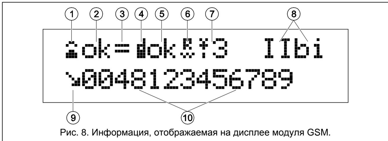
Рис. 8. Информация, отображаемая на дисплее модуля GSM.
