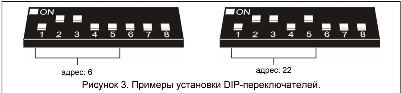
5 переключателей позволяет установить адреса 32 модулей расширения (числа от 0 до 31). Адреса модулей расширения, подключенных к одной шине, не могут повторяться, зато последовательность адресации произвольная. Модулям расширения и модулям, подключенным к одной шине, рекомендуется назначать последовательные адреса, начиная с 0. Это позволит избежать проблем при расширении системы.
