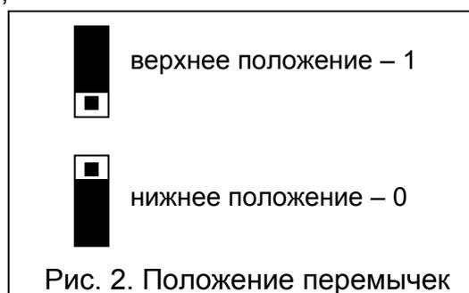
передачу извещения о состоянии зон: Z3 и Z4 (перемычка C1), а также Z5 и Z6 (перемычка C2). Перемычки модуля расширения всегда должны находиться в верхнем или в нижнем положении. Запрещается совсем снимать перемычки.
