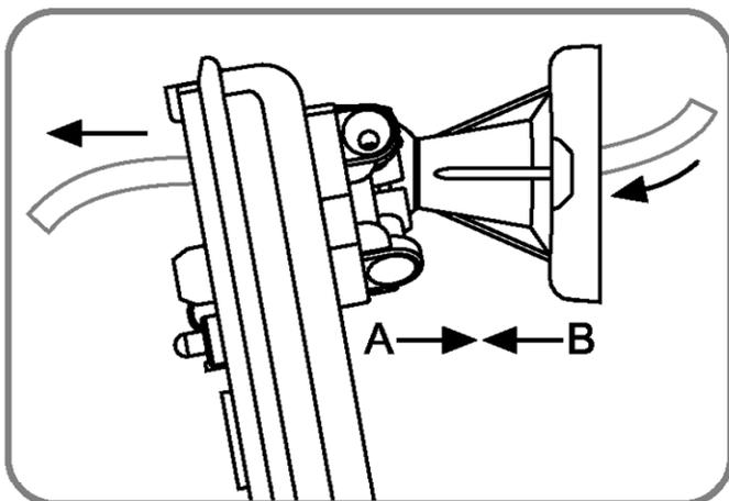
3. Сделайте отверстие на задней стенке извещателя для запуска провода. Проведите провод через компонент "А" внутрь извещателя. Прикрепите заднюю крышку извещателя (компонент "А") к компоненту "В".
