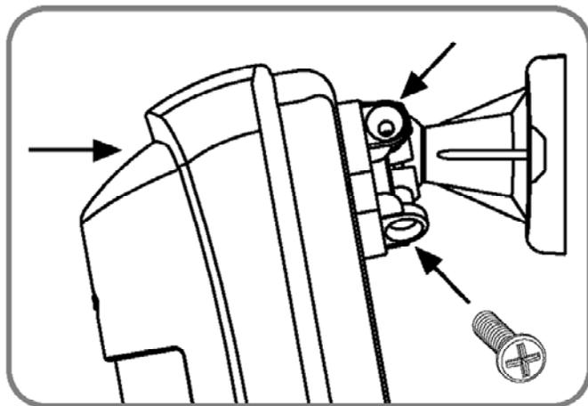
4. Подключите провод к клеммам терминального блока и закройте верхнюю крышку извещателя. Отрегулируйте желательный угол и зафиксируйте с помощью двух винтов.
