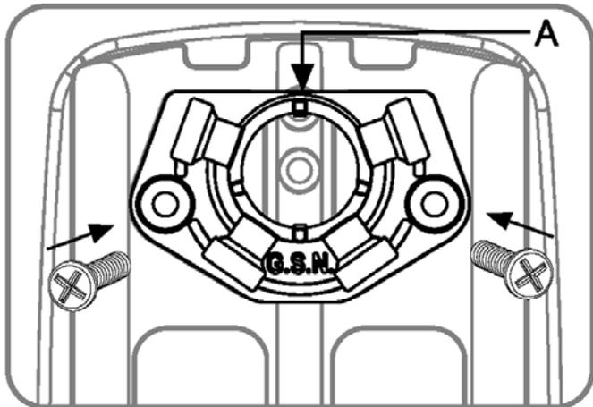
1. Установите компонент "А" на задней крышке извещателя и закрепите его двумя винтами.
