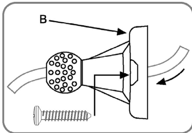
2. Пропустите провод через компонент "В". Закрепите компонент "В" на стене с помощью двух винтов.
